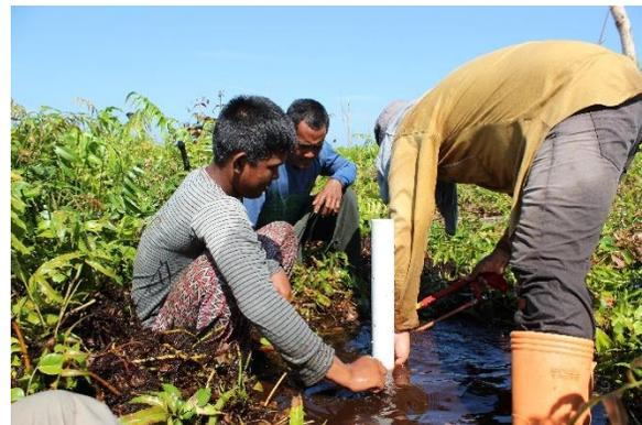
Pemasangan piezometer untuk mengetahui tinggi muka air tanah/genangan air
